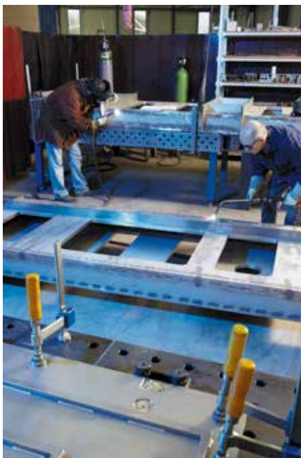
Verzüge durch Schweißen und mechanische Bearbeitung werden auf unseren Vorrichtungen präzise in Form gebracht.
